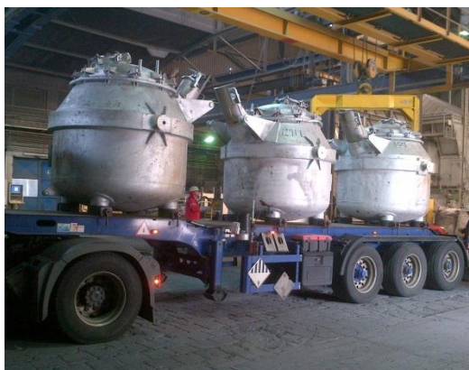
Auflieger mit Transportwarmhaltetiegeln für Flüssialuminium und angebaute SMITH-Sensorik (in der Mitte zwischen den beiden Behältnissen) bei der Aleris Recycling GmbH (Quelle: Aleris/ISL)
