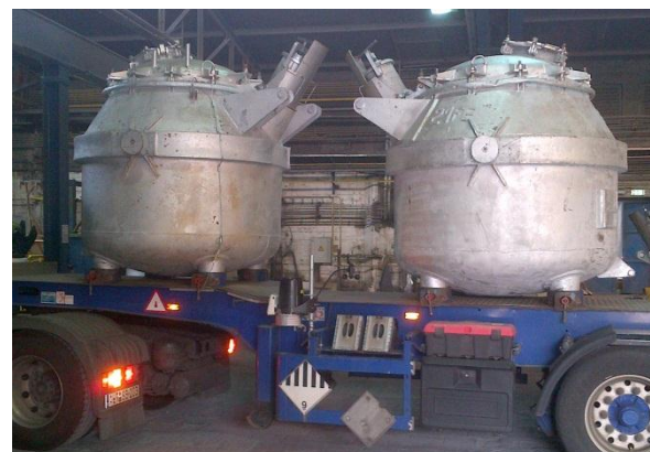
Auflieger mit Transportwarmhaltetiegeln für Flüssialuminium und angebaute SMITH-Sensorik (in der Mitte zwischen den beiden Behältnissen) bei der Aleris Recycling GmbH (Quelle: Aleris/ISL)
