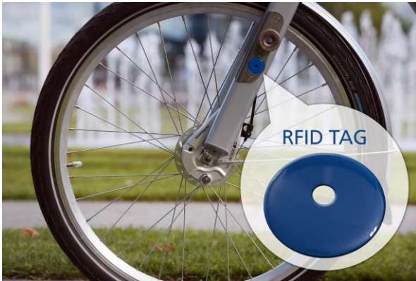
Bild 1: nextbike RFID Epoxy Tag
