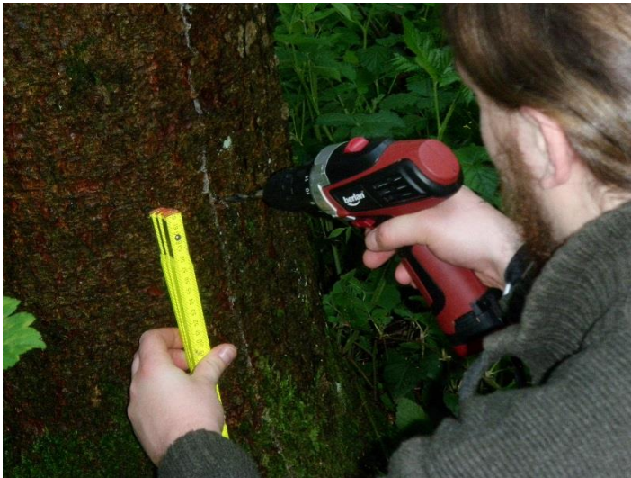
Abbildung 3 – Einbringung des RFID-Transponders (TYP 1) in den Baumstamm
