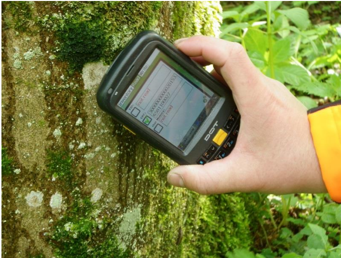
Abbildung 4 – Auslesen bzw. Beschreiben eines RFID-Transponders mit einem mobilen RFID-Schreib-/Lesegerät
