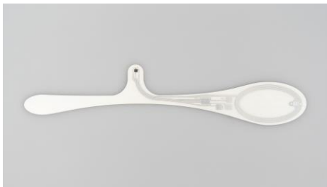
3. smart-LABEL BodyTemp mit integriertem NFC-Sensor-Chip
