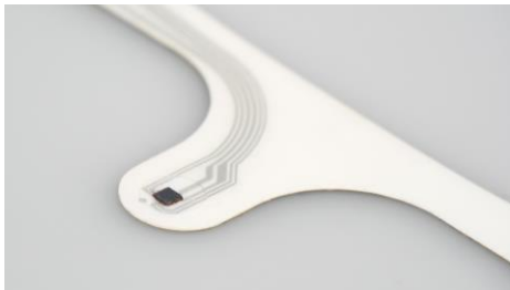
4. NFC-Sensor-Chip in Großansicht
